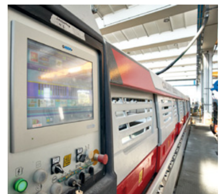
Neu hinzugekommen ist die Poliermaschine Galaxy B220GX von Pedrini. Mit ihr werden Platten poliert, geschliffen oder satiniert.
